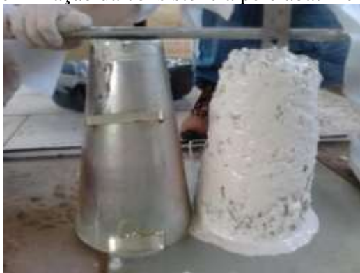
Figura 1 - Ensaio para determinação da consistência pelo abatimento de cone de tronco
