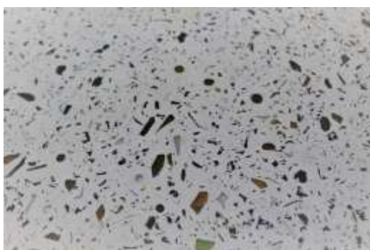
Figura 4 - Aspecto final da rocha artificial produzida com vidro cominuído e pó de rocha
