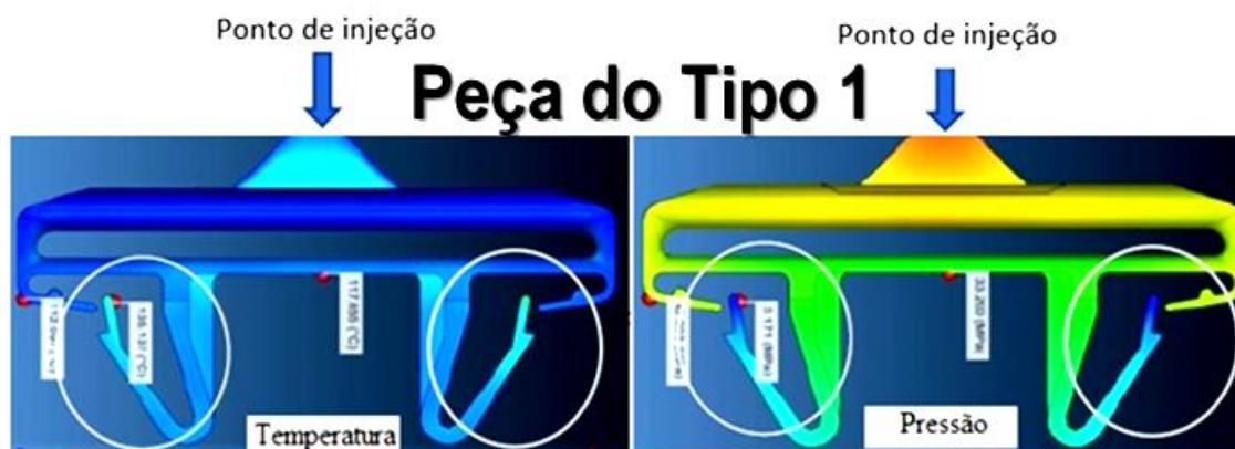
Figura 8 - Análise da simulação computacional na peça do tipo 1. As regiões destacadas com círculos (cor branca) mostram a parte mais crítica na fabricação.
