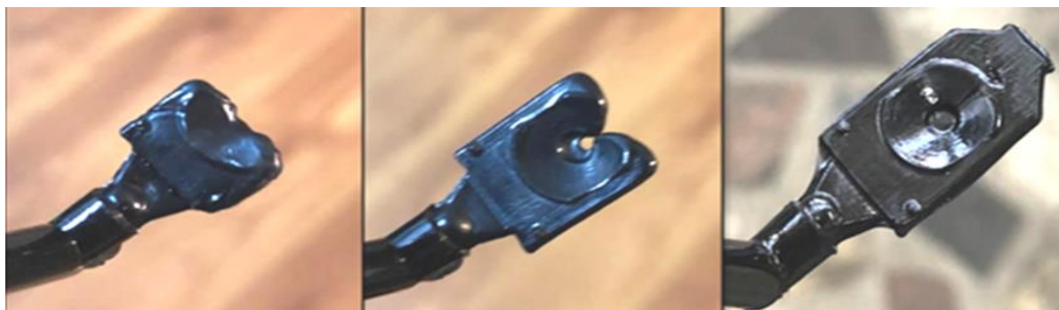
Figura 9 - Teste de preenchimento incompleto da peça tipo 2 em molde mecânico híbrido.
