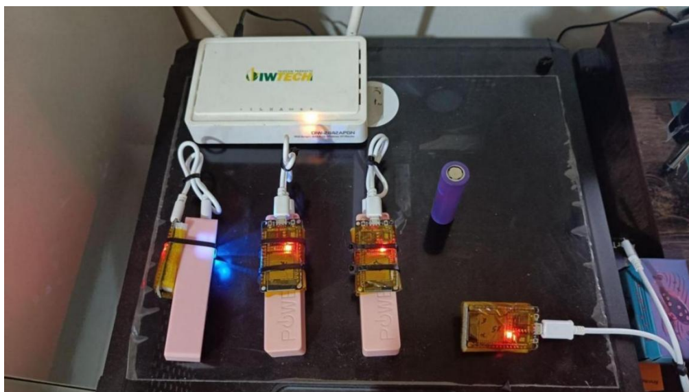
Figura 4 – Nó raiz, nós clientes (sensores), bateria e o AP ( Access Point ) utilizado nos testes.
